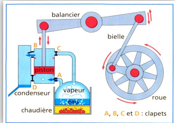
Doc 1 : La machine à vapeur de James Watt a d'abord été utilisée pour pomper l'eau des mines, puis dans d'autres domaines industriels.
